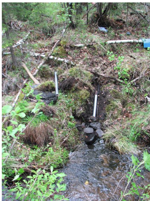
Рис. 7. Установка датчиков уровня и температуры воды в русле ручья Ихубур (а), контроллера (накопителя данных) и датчика атмосферного давления (б).
