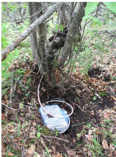
Рис. 7. Установка датчиков уровня и температуры воды в русле ручья Ихубур (а), контроллера (накопителя данных) и датчика атмосферного давления (б).
